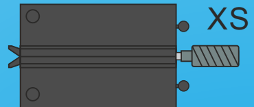
XM Motor 47:1; 338 U/min 0,95 A 8,4 Ncm (größerer Motor als beim Encodermotor)
